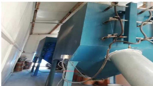
陶瓷粉末喷涂 2 套袋式除尘器和标志牌
