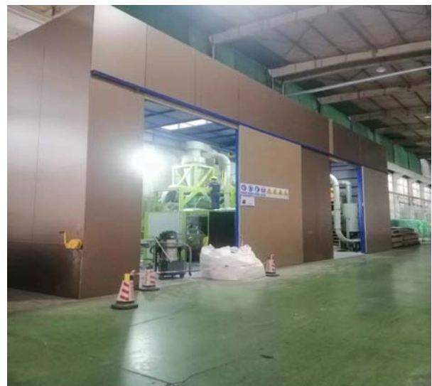
研磨机单独隔间+棚顶 (5m×6m×3m)
